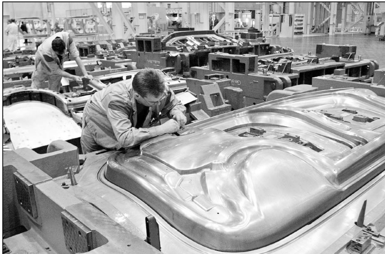
عمال في مصنع فولكس فاغن الجديد في مدينة ايمدن الالمانية (سكسونيا السطى) يعدون قوالب لاجزاء من اجسام السيارات استعدادا لافتح المصنع الذي كلف 140 مليون يورو
