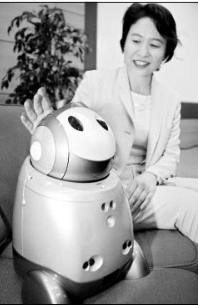
مستخدمة في شركة ان سي بي اليابانية للالكترونيات «تخاد» روبوت من انتاج الشركة القادر على تمييز الأصوات البشرية وتعبيرات الوجه والرد على محادثته
