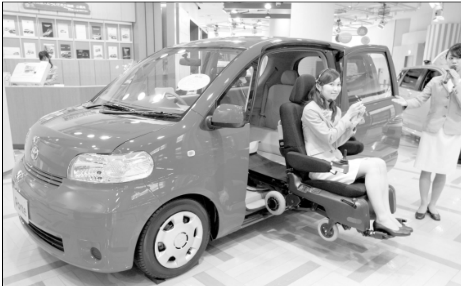
عروضتان تقدمان سيارة تويوتا جديدة مجهزة بطريقة تسمح للمعوقين بقيادةها من القسي المنقل الخاص بهم
