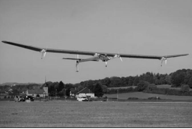
وبدأت الطائرة التي تحتاج الى 12 الف خلية شمسية رحلتها الاولى في نيسان/ابريل 2010 وبعد ذلك بثلاثة اشهر اكملت رحلة استمرت 26 ساعة وهو وقت تحليق قياسي بالنسبة لطائرة تعمل بالطاقة الشمسية. ويبلغ متوسط سرعة طيران سولار امبالس 70 كيلومترا في الساعة مما لا يجعلها تهديدا قويا للطائرات التجارية التي يمكنها بسهولة الانطلاق بما يزيد على عشرة أمثال هذه السرعة.
