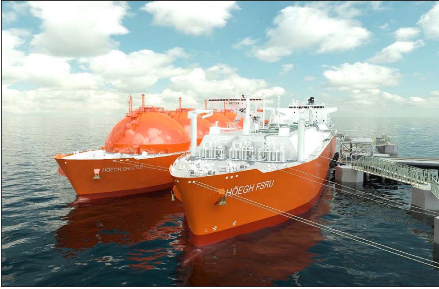
سفينتان تابعتان لشركة «هوغ» احدهما (يسار) ناقلة الى الغاز المسال والأخرى لاعادته الى غاز سائل
