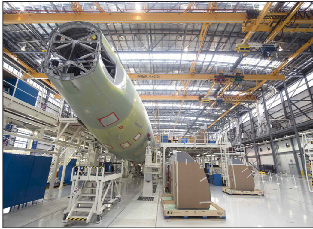
جزء من جسم طائرة «إيه 320» في عتبر التجميع في مصنع إيرباص، في ولاية ألاباما الأمريكية
