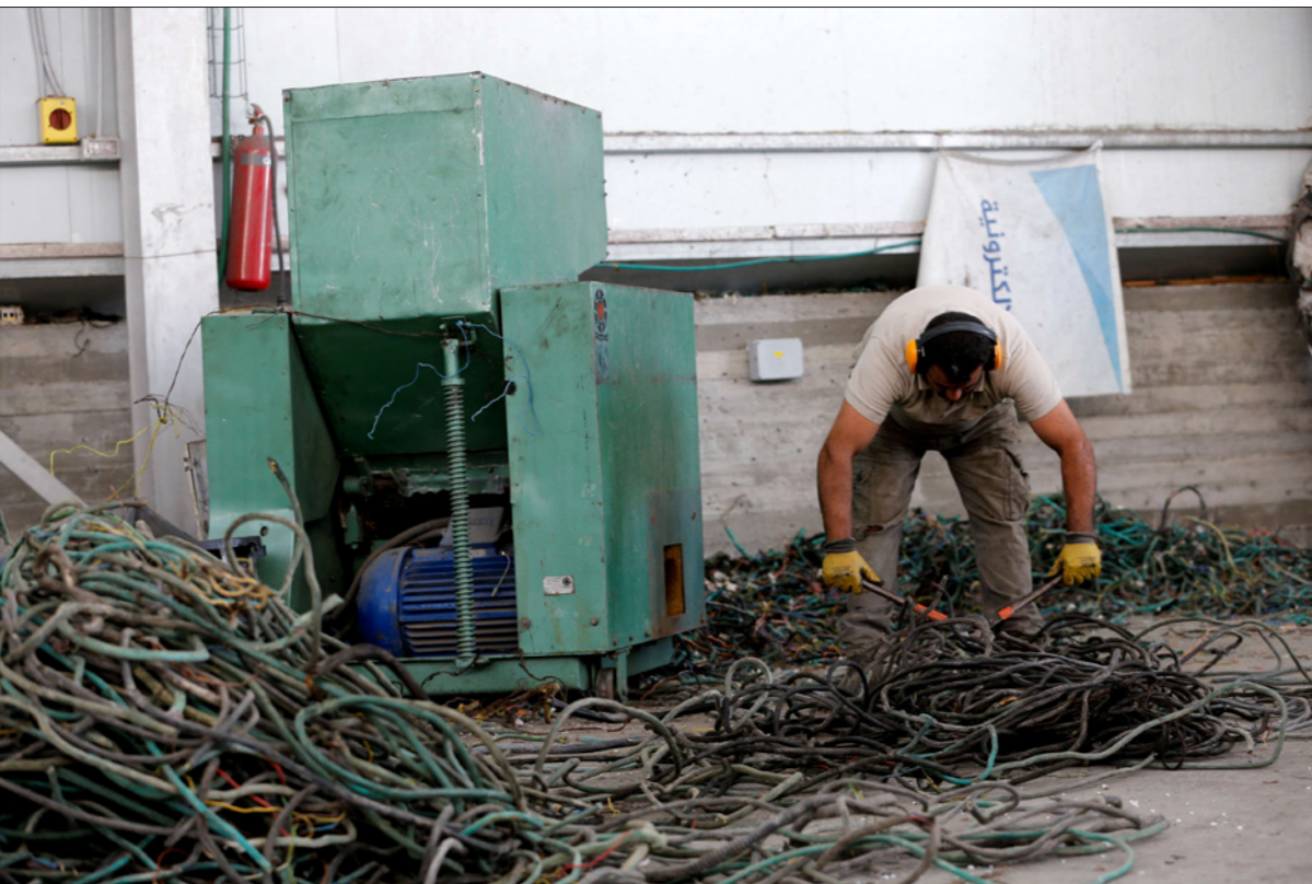
عامل في مركز إزنا يفرض الكوابل الكهربائية لاستخراج ومعالجة المعادن الموجودة فيها
