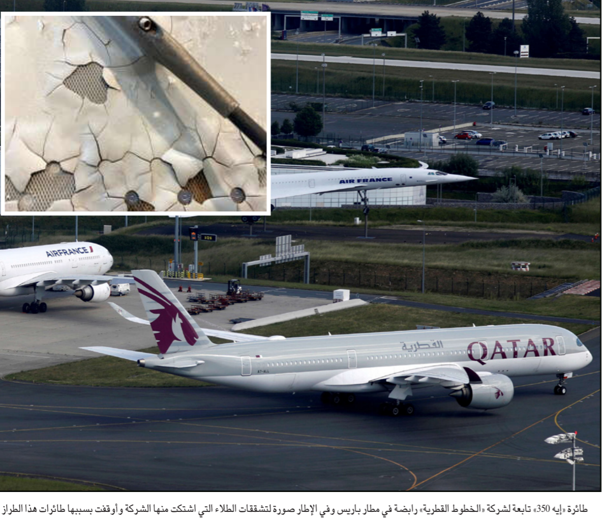
طائرة إيه 350 تابعة لشركة «الخطوط القطرية»، رابضة في مطار باريس وفي الإطار صورة تشققات الطلاء التي اشتمت منها الشركة وأوقفت بسببها طائرات هذا الطراز
